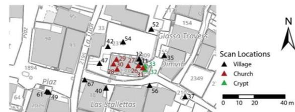
Figure 27. Laser scans position
